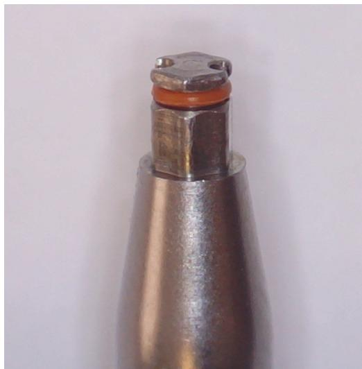
Slika 6: Alat za umetanje sa montiranim O-ring
