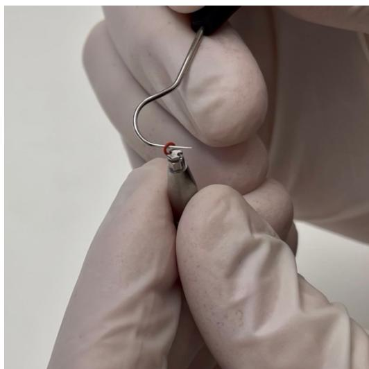
Slika 2: Postavite O-ring na kraj alata za umetanje
