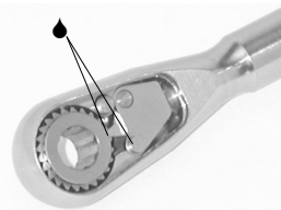
Abb. 6 Kontaktzone zwischen den Zähnen des Ratschenrads (1) und der Drehpunkt der Ratsche (2) (▲) wie auf Abb. 6 angezeigt. Überschüssiges Fett auf der Außenseite des Drehmomentschlüssels entfernen, denn es würde während dem Sterilisieren über die Oberfläche des Instruments rinnen. Ausschließlich das Instrumentenfett INSTRUMENT LUBRICANT, welches mit dem Drehmomentschlüssel geliefert wird, verwenden.
