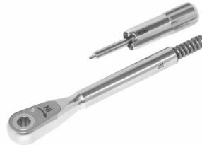
Abb. 2 Drehmoment-Stellschraube (7) ganz lösen und Feder / Anschlag (6) aus dem Ratschengriff ziehen.
