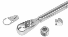
Abb. 4 Der Ratschenkopf (4) enthält die zwei zu entnehmenden Elemente : Die Ratsche (2) und das Ratschenrad (1). Die Schraube (5) ist im Ratschenkopf fixiert.
