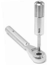
Abb. 7 Nach dem Einsetzen der Bauteile (1) und (2), den Deckel (3) auf den Ratschenkopf setzen, festhalten und dann den Drehmomentschlüssel umdrehen. Mit der Schraube (5) und dem Sechskant (7), den Deckel fest auf den Ratschenkopf (4) schrauben.
