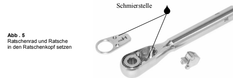
Abb. 5 Um den Drehmomentschlüssel richtig zu montieren, muss man die folgenden Elemente in der richtigen Reihenfolge zusammensetzen : zuerst das Ratschenrad (1), dann die Ratsche (2)
