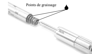
Fig. 8 Insérer l'ensemble ressort/butée à l'intérieur du manche et visser le poullet de réglage.
